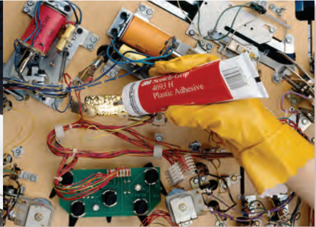
Flipperipelin korjauksessa 3M Scotch-Weld™ 4693 (SW 7312) -liimalla kiinnitetään läpinäkyvät, muoviset koristeosat.
