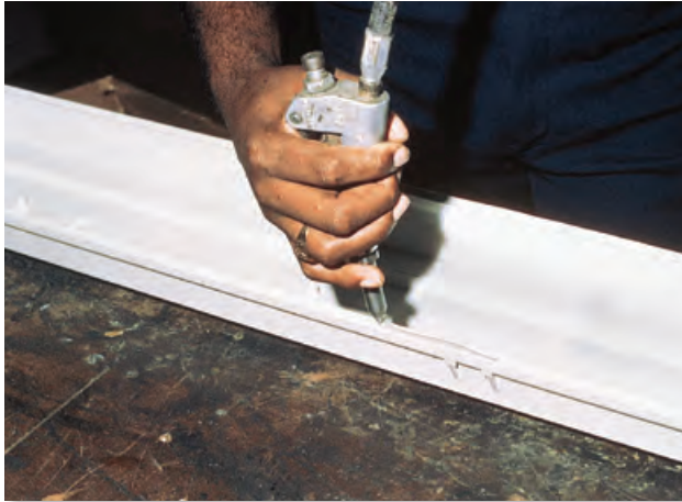
Kosteuden tunkeutuminen valotauluun estetään liimaamalla kumiiviste paineilmakäyttöisen liimauslaitteen avulla.
