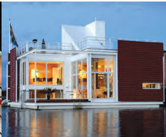
Compo AB on toimittanut sisäkattoja, lattiaita ja seiniä tähän vedessä kelluvaan Villa Waterlily -rakennukseen. 18,6 cm:n lasikuituvahvistetut paneelit on asennettu ilman ensimmäistäkään naulaa tai ruuvia. Ratkaisu on 3M VHB-teippi.
