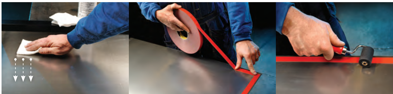
Vaihe A: Puhdista pinta isopropyylialkoholi-vesiseoksella (1:1 enintään 50 % vettä) ja kuivaa pinta.
