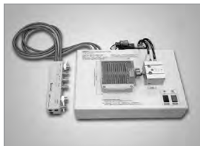
A132501 : Auto Transformer Scanning Box (3001A)
